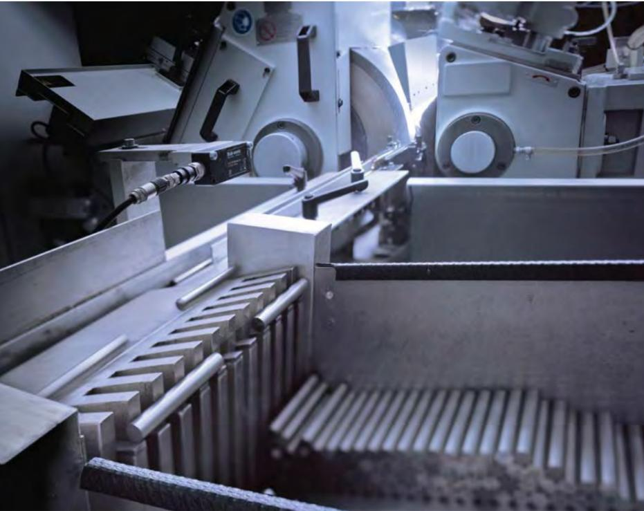
Zähigkeit, Rundheit, Biegefähigkeit und hohe Temperaturleitfähigkeit sind entscheidende Parameter bei der Rohlingsproduktion. Hier Hartmetall-Rohlinge in einer Centerless-Schleifmaschine
