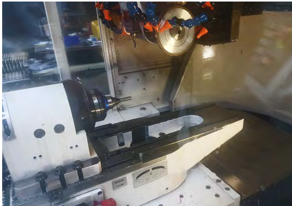
Werkzeugrohling und das \mu Grind Schnellspannfutter auf der Maschine
