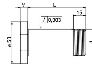
Lieferung bestückt: mit Einbausystem, Ringsatz  $\phi 50$  mm, Sicherungsblech und Spannmutter ANCA mit Wuchtbohrung
